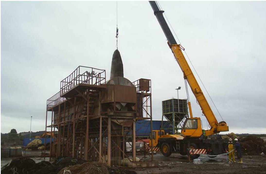
Figura 3.3: Carga de mallas de cultivo en hidrolavadora
